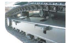
●泥落ちしやすい片流れ構造のクローラフレーム。
