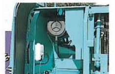
●ペール缶や予備ツースなどを収納できるトランクルーム。
