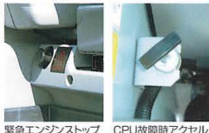
緊急エンジンストップ (シート下) CPU故障時アクセル (シート右)
