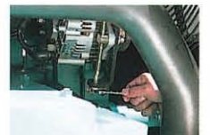
●ネジ式で微調整ができるファンベルト。
