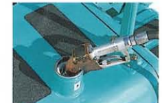
●自動給油にも対応できる大型燃料給油口。
