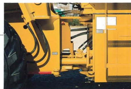
車の下へもぐらなくてもよいように、グリースアップ箇所を外へ引出しています。
