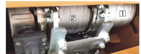
① DOC:ディーゼル酸化触媒 ② DPF:ディーゼルパーティキュレートフィルタ
