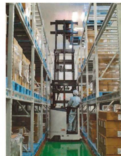
車幅とほぼ同等の通路幅で荷役作業ができ、スペースを有効利用。
