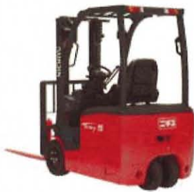
■トリンカ 業界初のデジタル荷重計を標準装備。 走行・荷役用にAC制御を採用し、パワフル&スムーズな動きを実現。
